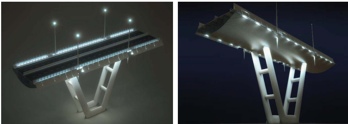
Figura 8-8. Viste di dettaglio delle pile a "V" e di un tratto di impalcato in rettilineo
