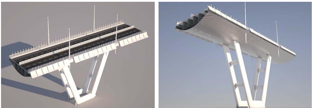
Figura 8-6. Viste di dettaglio delle pile a "V" e di un tratto di impalcato in rettifilo
